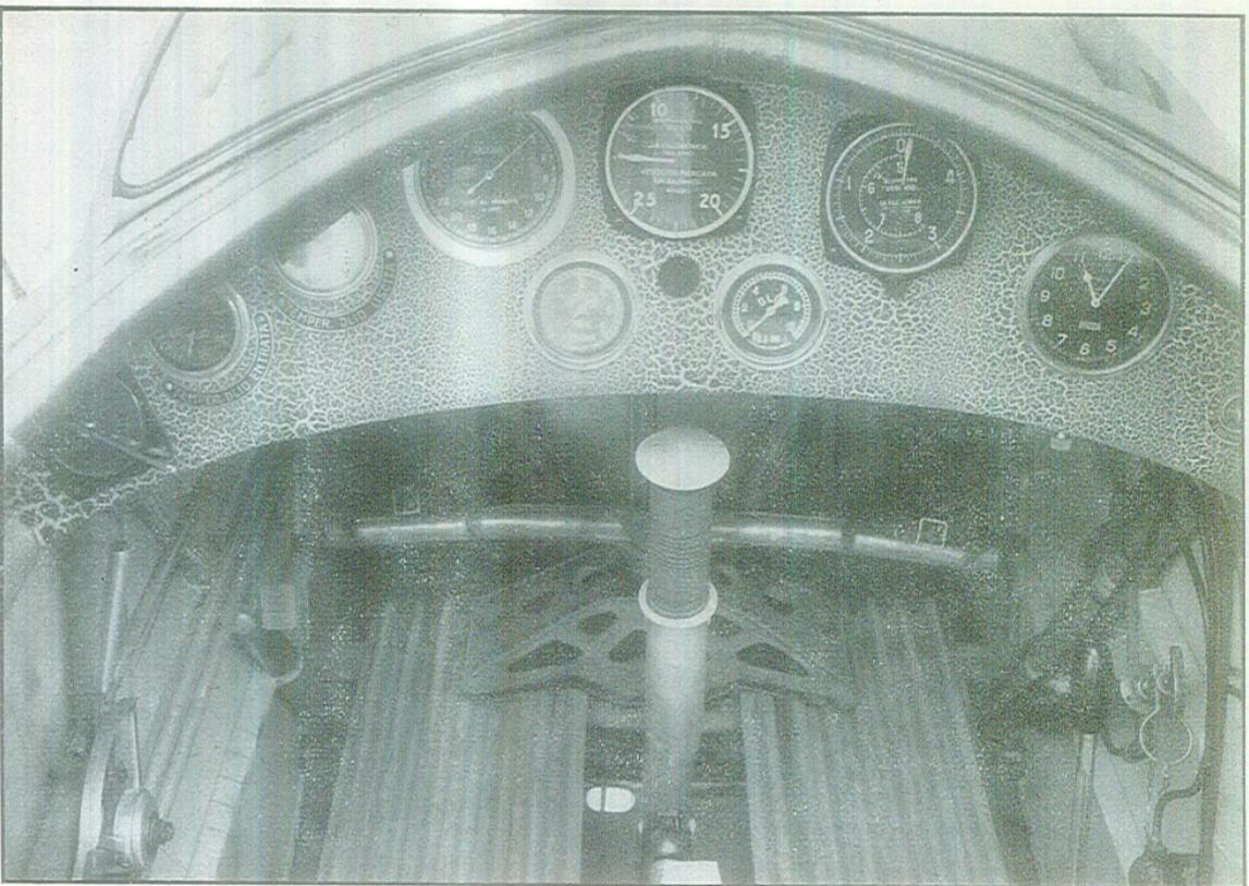
Fig. 28 Quadro strumenti di bordo
